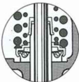
Rotocap unter den Auslassventilfedern.
